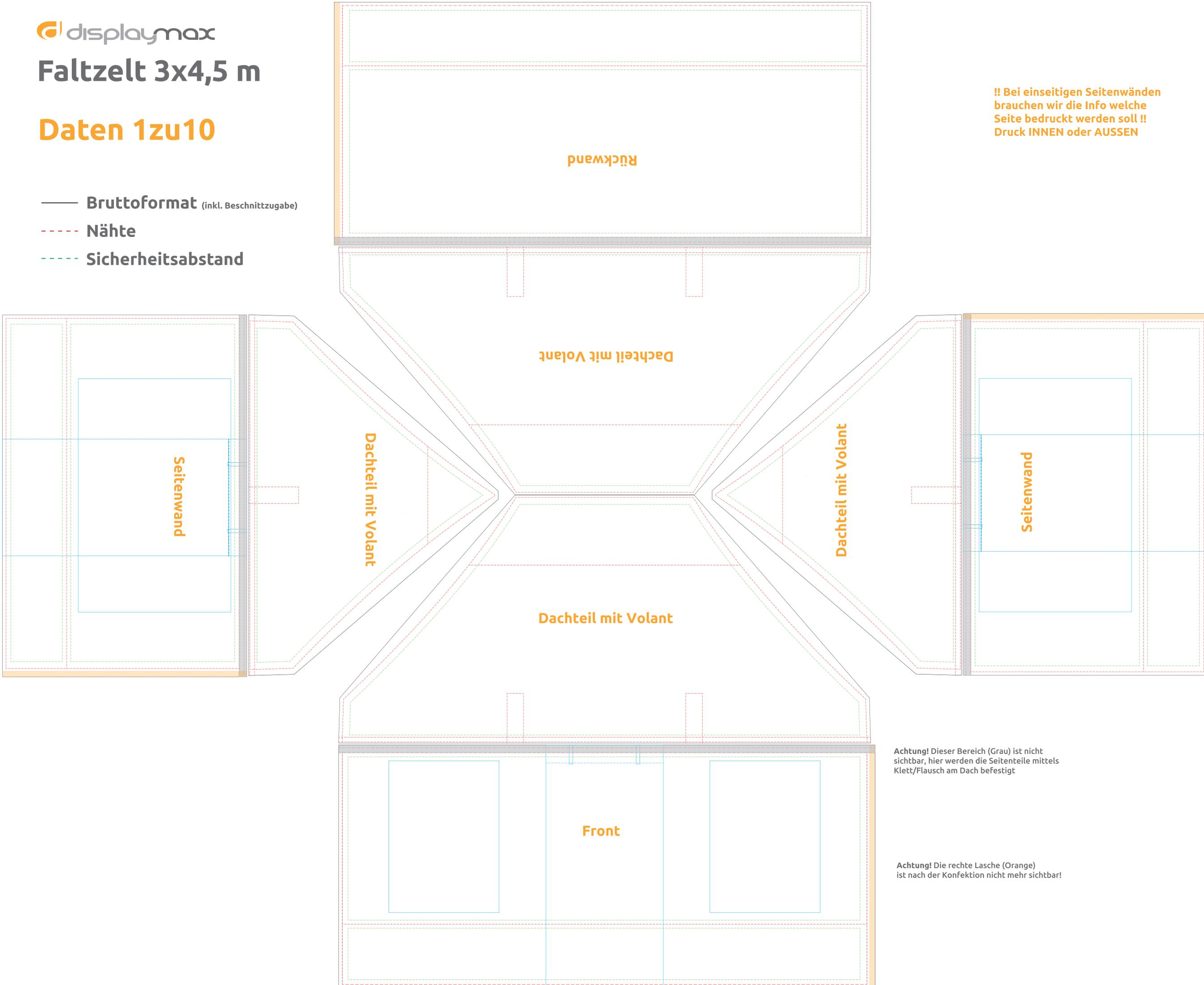
Achtung! Dieser Bereich (Grau) ist nicht sichtbar, hier werden die Seitenteile mittels Klett/Flasch am Dach befestigt
